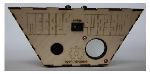
FIGURE 36. THE SPEAKER PORT (LEFT) AND THE SPEAKER (RIGHT)
